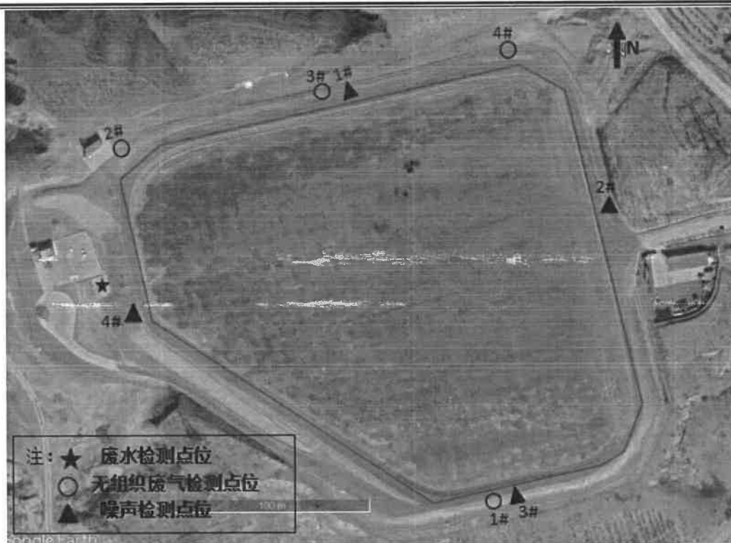
图1 废水、废气及噪声检测点位示意图
